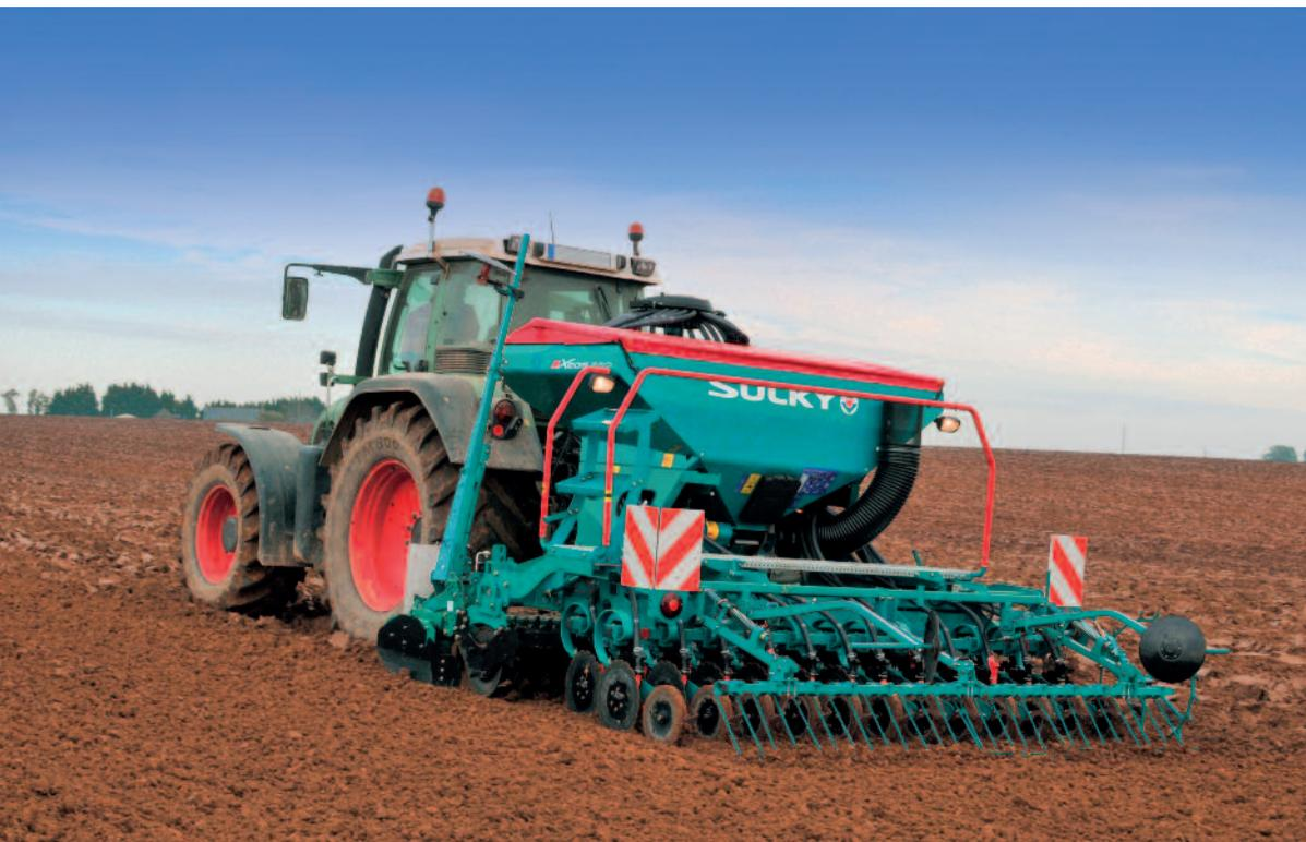
Le terrage de type forcé du XEOS PRO allié à l'intérêt de la herse rotative à 4 rotors au mètre : une technique de semis « toutes conditions ».
